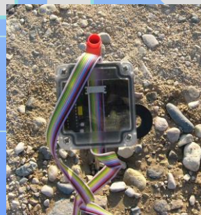
Sistema di acquisizione dei dati 4point ActEle Elettrodi attivi light hp geoelettrica tomografica
