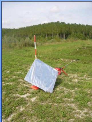
Riflettore in alluminio utilizzato come marker per ubicare i fotogrammi termografici
